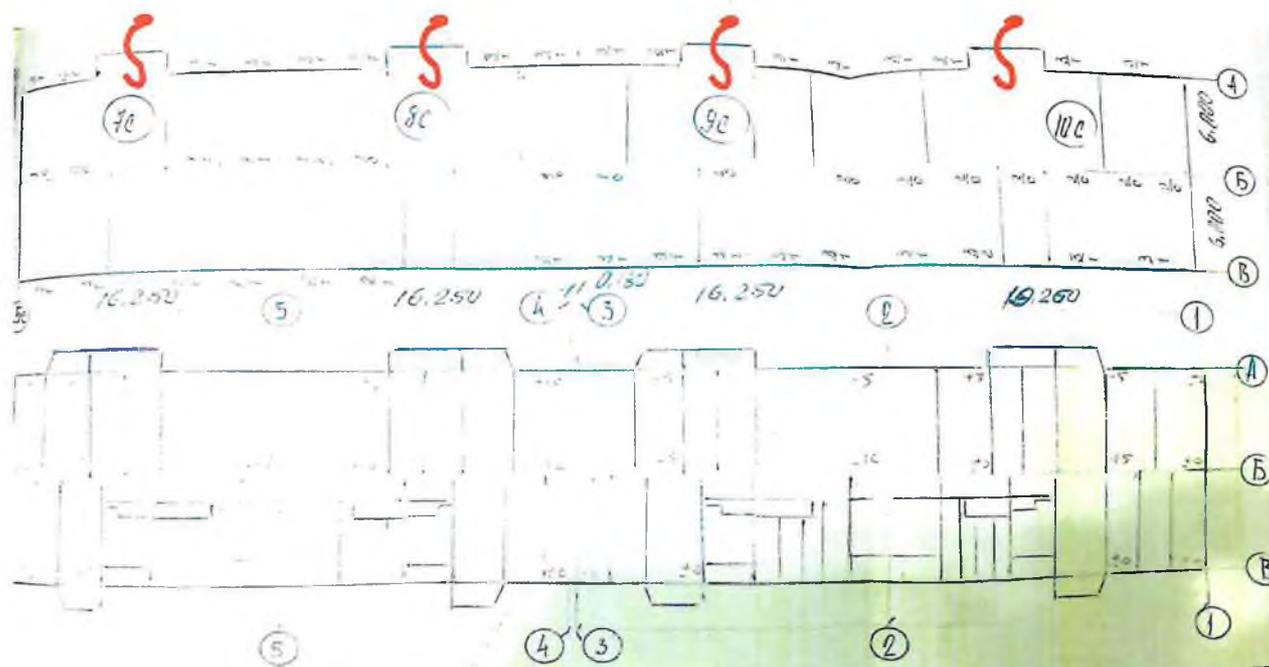
Фото №13. План подвала с массовыми типовыми дефектами наличие одной сквозной вертикальной +/- 30 град трещиной наружных стеновых панелей (на схеме указано красным), расположенной в средней части пролета +/- 0,3 м. См совместно с фото ниже
